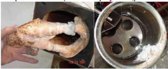
*圖：中國車輛不良AdBlue造成SCR觸媒之損害
